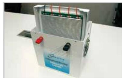
SimpleBMSはバッテリー充電時の過度なばらつきを防止するための制御基板です。充電時に各セルの電圧を監視し、セル電圧が3.7V以上になった際に熱として放電し、セル間のばらつき及び通常使用における過充電を防止します。※1
