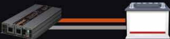
インバーター電源スイッチの消し忘れや12V負荷の消し忘れをしてしまうと微弱な放電を続けてしまい、バッテリーが過放電の状態になってしまいます。
