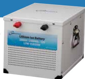
キャンピングカーのシートは座りやすい座面高400mmを実現する為、バッテリー庫の高さは300mm程度に設計されています。200AHLOW-VERSIONIは高さ300mmのバッテリー庫に収まるように高さ275mmを実現しました。
