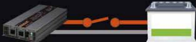
バッテリーセーバーは電圧を常時監視し、規定の電圧以下になるとリレーでインバーター等の負荷装置とバッテリーの接続を遮断し過度な過放電を予防します。
