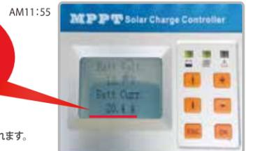
発電量:280W / 充電電流:20.4A / バッテリー電圧:13.7V
