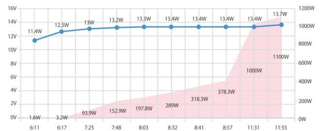
11:55時点で電力の積算が約1100Whに達しており、リチウムイオンバッテリー100Ah (1200Wh)をほぼ満充電となった。その後すぐにMPPT充電コントローラーはフロート充電へ移行し充電を停止しました。
