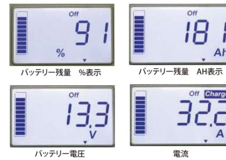
ボトロニックバッテリー残量計はシャントに流れている電流値を計測する事により電池残量を正確に表示することが可能となります。
