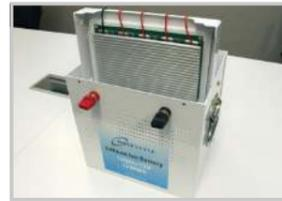
SimpleBMSはバッテリー充電時の過度なばらつきを防止するための制御基板です。
