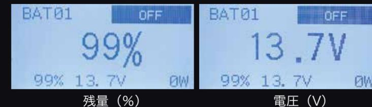
電圧だけでは把握できないリチウムイオンバッテリーの残量を、まるでスマートホンの残量を見るように正確に表示します。
